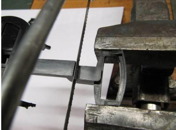
Sägen Sie die alte Kupplungsöse nahe an dem Absatz ab.
