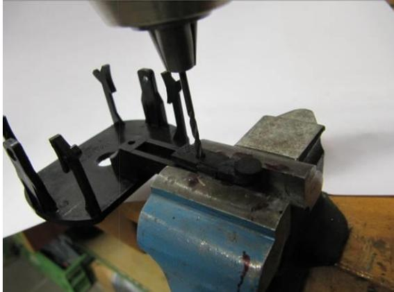
Bohren Sie mit einem 2 mm Bohrer ein Loch mittig zum 3 mm Loch des Adapters.
