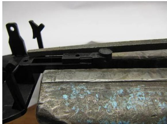
Setzen Sie das Adapterstück ein und feilen außen bündig ab
