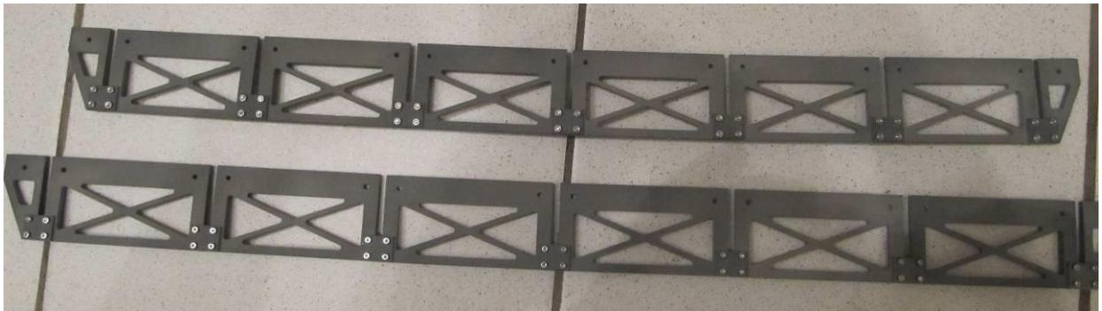
Bild 2 (oben Längsträger innen, unten Längsträger außen)
