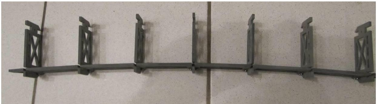
Bild 3 Aufstecken der Querträger
