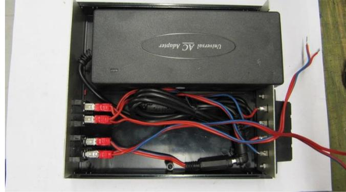
Das Kabel mit den 22 Volt vom Netzteil wird zunächst zweipolig über den Hauptschalter geführt und speist dann die Zentrale
