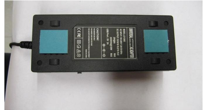
Klebeband unten anbringen, Netzteil wird in die Unterschale eingeklebt.
